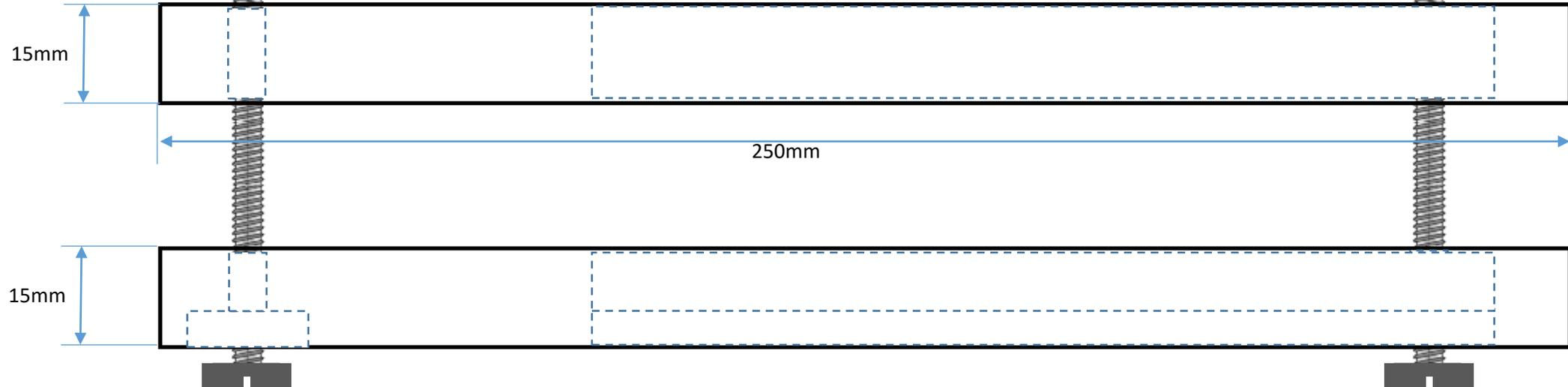
Deux petites plaques d'aluminium afin d'éviter au boulon d'endommager la lumière.
